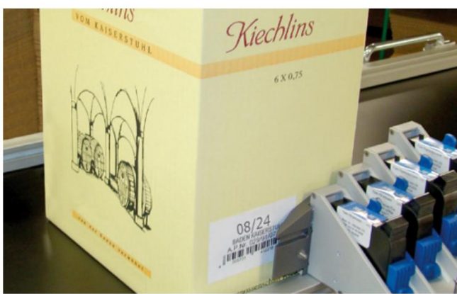
Zastępowanie etykiet na kartonach do wina (REA JET HR)
