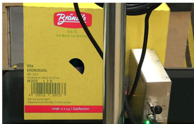
Druk na kartonach za pomocą REA JET GK 2.0
