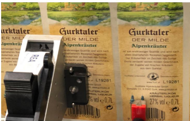
Znakowanie etykiet na butelkach (REA JET HR)
