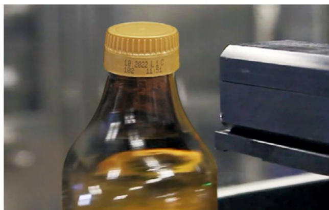
Znakowanie plastikowych wieczek (REA JET SC 2.0)
