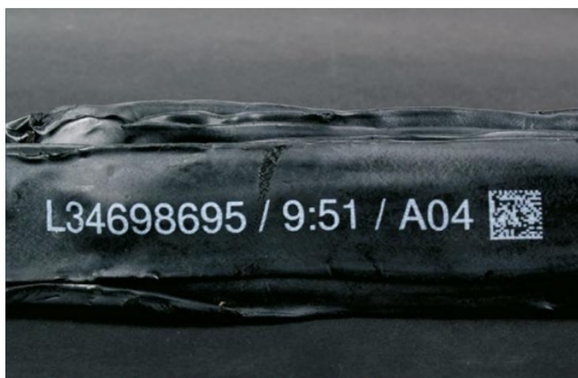
Kod 2D na niewulkanizowanej gumie, naniesiony systemem wielkoznakowym Ink Jet
