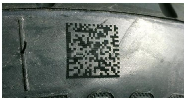
Trwałe znakowanie laserowe gotowej opony kodem 2D
