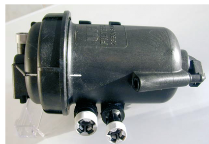
Linie pomocnicze do poprawnego montażu
