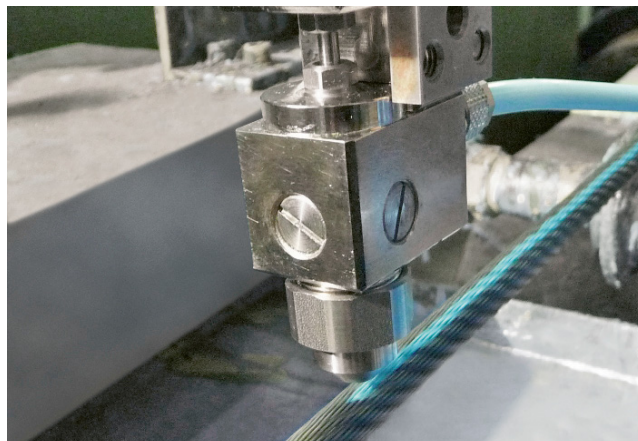
Nadruk linii na linach stalowych do wind osobowych jako pomoc montażowa (znaki skrętu)
