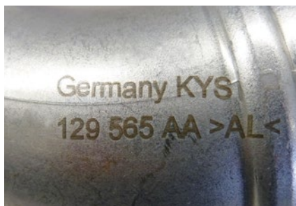
Znakowanie części metalowych
